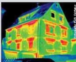
Die Gebäude-Thermographie zeigt, wo Wärmebrücken drohen: An Fenstern, Türen, Fugen und Verbindungsstellen. Also überall dort, wo die Wärmedämmung durchbrochen wird. Mit fischer Thermax bleibt die Wärme drinnen. fischer Thermax verhindert die Wärmebrücke. Schnell, einfach, effektiv.
