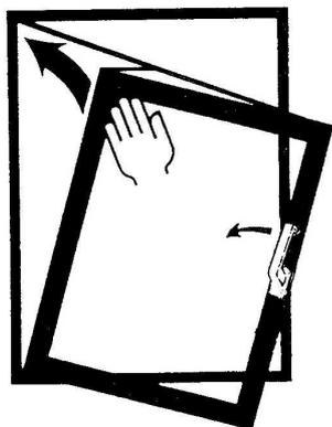
Gelangt der in Drehstellung geöffnete Flügel - nach versehentlicher Überschaltung des Bedienungsriffes - einmal in eine oben von der Schere gelöste Neigungs-Drehstellung, dann ist dies problemlos. Der Flügel kann nämlich leicht und gefahrlos wieder in seine ordnungsgemäße Drehstellung zurückgeführt werden. (siehe Skizze).
